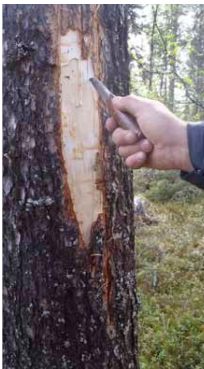
Bildet viser hvordan man tester treet for vridning.
