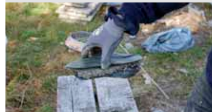
Leirmørtel kastes på en stein og en annen stein presses mot mørtelen. Her vises vedheft.
