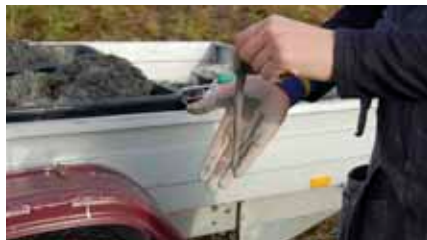
Leire rullet ut mellom hendene. Jo lengre leirpølse man kan rulle ut slik bildet viser, jo bedre er kvaliteten.
