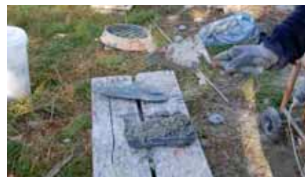
Leirmørtel kastes på en stein og en annen stein presses mot mørtelen. Her vises vedheft.
